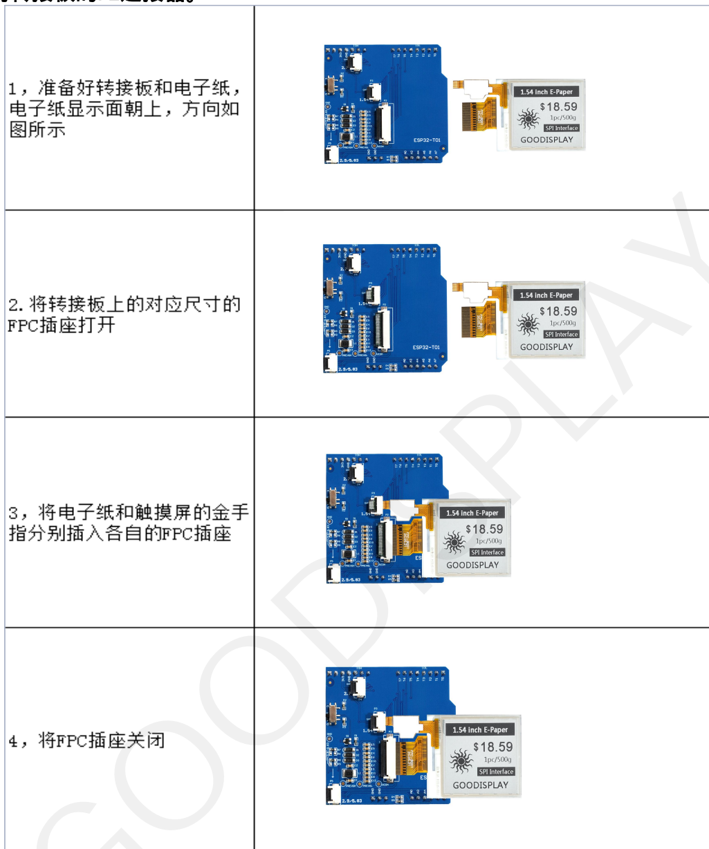
图 2 电子纸显示屏与转接板连接方式
